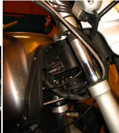
Montieren Sie den leitung an der Rahmen, und führe es langs der motorrad nach vorne nach der Handbremspumpe.
