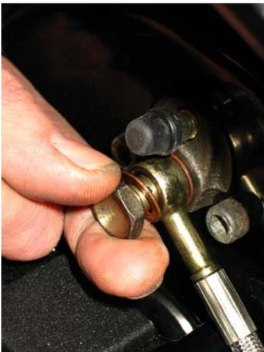
Die Bremsleitung soll auf gezeigte Weise (siehe bild) nach Hinten/Unten mit Kupferringen befestigt werden.
