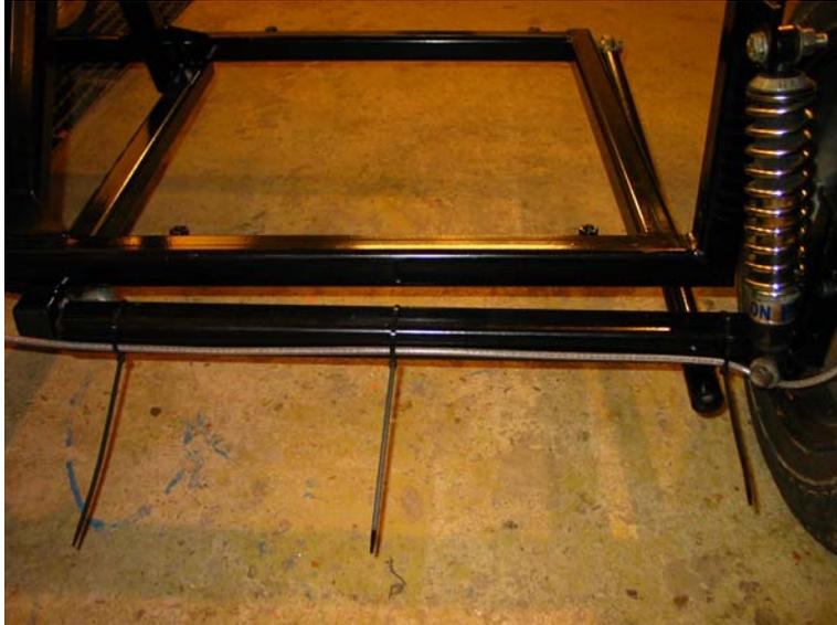
Montiere die Bremsleitung mit Tie-raps an die Radaufhängung (Siehe Bild). **Achtung!!! Die Bremsleitung muss unbedingt frei sein bei die ganze Federbewegung und auf keinen fall unter das Rahmenrohr befestigt werden!!!**
