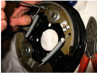
Montiere die Zugfedern zwischen die Bremsschuhe. Die leichte Zugfeder kommt an die seite von Bremszylinder.
