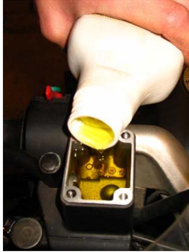
Folgen Sie für das Entlüften von das Bremssystem die Hinweisen aus ein original BMW Werkstatthandbuch; Entlüften Sie Nicht nur der Seitenwagenbremse, aber auch die Motorrad Vorderradbremse!
