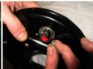
Montieren Sie den Bremszylinder. Die Druckkolben von Bremszylinder müssen eingedrückt werden um den Bremszylinder zwischen die Bremschuhe zu bringen. Die Bremschuhe müssen in die Aussparungen von die Druckkolben passen. Befestigen Sie den Bremszylinder mit zwei M6x8 Bolzen.
