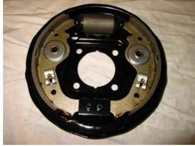
Montiere die Haltestifften für die Bremschuhe durch die Bremsankerplatte und dan durch die Bremsschuhe. Sicheren mit die Federklemmen.
