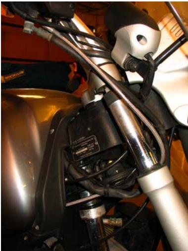
Montieren Sie auch an der Vorderseite der Bremsleitung derart dass auch bei voller lenkeinschlag der Leitung nicht eingeklemmt wird, und nicht verspannt wird.
