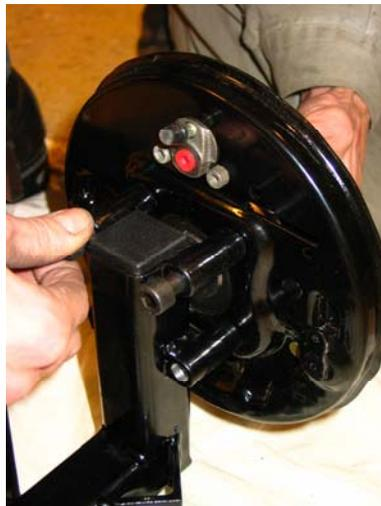
Plazier der bremsankerplatte über die Bolzen womit der radlager befestigt wird. Der Bemszylinder muss sich dabei an der Oberseite befinden. Streichen Sie die M10x60 Bolzen ein mit Schraubensicherungsflüssigkeit. **Achtung!!! Dieser Bolzen nie ersätzen mit Bolzen von weniger kwaliteit!!!** Anzugmoment: 40 Nm
